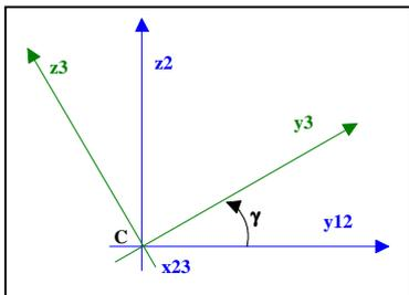
Dans un mouvement en rotation autour de l'axe (C, x<sub>23</sub>) du repère R<sub>3</sub>(x<sub>3</sub>, y<sub>3</sub>, z<sub>3</sub>) par rapport au repère R<sub>2</sub>(x<sub>2</sub>, y<sub>2</sub>, z<sub>2</sub>), tel que l'angle γ(t) est défini par (y<sub>12</sub>, y<sub>3</sub>), le vecteur rotation  $\vec{\Omega}_{R3/R2} = \dot{\gamma} \vec{x}_{23}$ .
