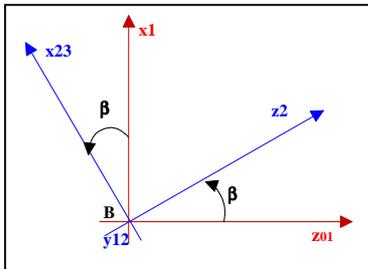
Dans un mouvement en rotation autour de l'axe (B, y<sub>12</sub>) du repère R<sub>2</sub>(x<sub>2</sub>, y<sub>2</sub>, z<sub>2</sub>) par rapport au repère R<sub>1</sub>(x<sub>1</sub>, y<sub>1</sub>, z<sub>1</sub>), tel que l'angle β(t) est défini par (x<sub>1</sub>, x<sub>23</sub>), le vecteur rotation  $\vec{\Omega}_{R2/R1} = \dot{\beta} \vec{y}_{12}$ .
