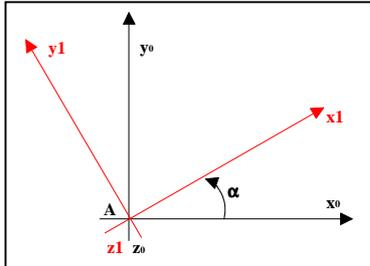
Dans un mouvement en rotation autour de l'axe (A, z<sub>10</sub>) du repère R<sub>1</sub>(x<sub>1</sub>, y<sub>1</sub>, z<sub>1</sub>) par rapport au repère R<sub>0</sub>(x<sub>0</sub>, y<sub>0</sub>, z<sub>0</sub>), tel que l'angle α(t) est défini par (x<sub>0</sub>, x<sub>1</sub>), le vecteur rotation  $\vec{\Omega}_{R1/R0} = \dot{\alpha} \vec{z}_{10}$ .
